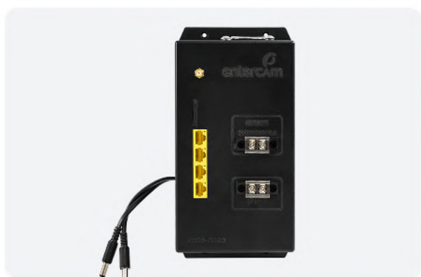
ПАК «Умный шлагбаум» без камер и антивандального корпуса
