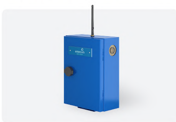
ПАК «Умный шлагбаум» со встроенными камерами и антивандальным корпусом
